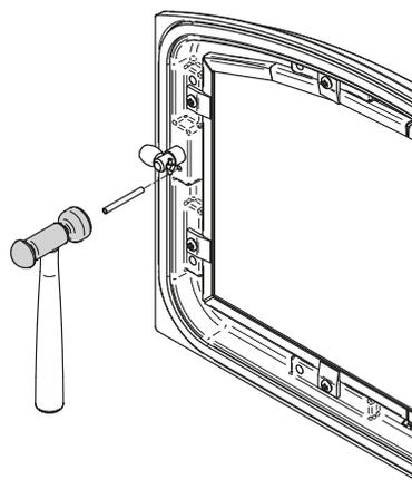
Figure 9 : Installation de la goupille de retenue
