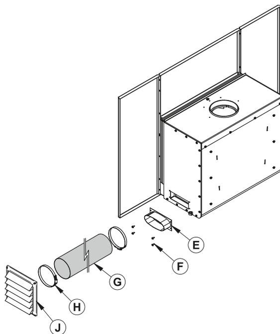
2. Installez l'adaptateur de prise d'air extérieur (**E**) à l'aide de 4 vis (**F**). Fixez un tuyau flexible<sup>1</sup> (**G**) sur l'adaptateur (**B**) à l'aide d'un des collets ajustables (**H**). Fixez l'autre extrémité au capuchon de prise d'air (**J**) à l'aide du deuxième collet ajustable (**H**). Le capuchon de prise d'air (**J**) doit être installé à l'extérieur de votre habitation.
