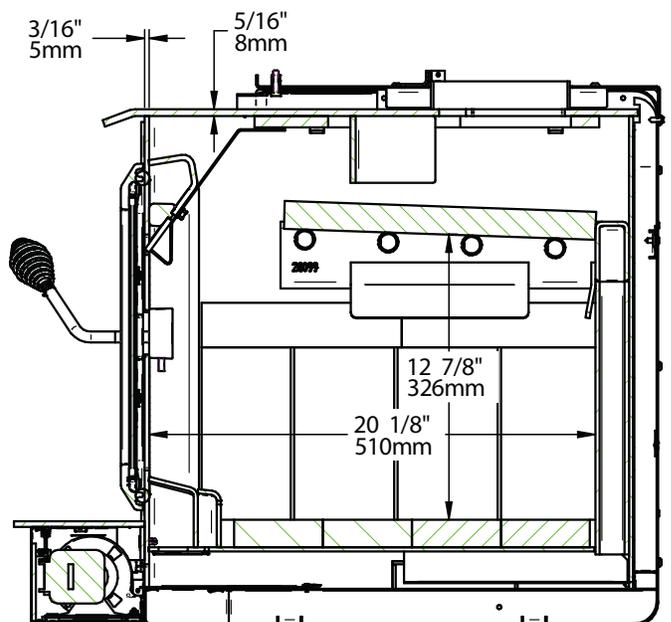
Figure 7 : Vue de côté - Chambre à combustion
