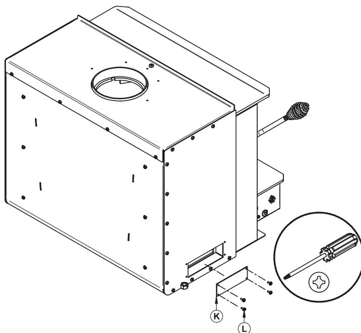
1. À l'aide de pinces, retirez la plaque métallique rectangulaire (**K**) retenue par les micro-joints afin de dégager l'ouverture prévue pour la prise d'air extérieur.
