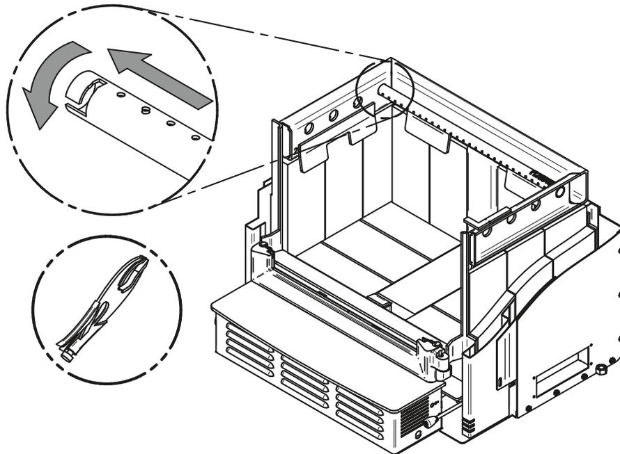
*Prendre note que n'importe quel tube (A) peut être remplacé sans retirer le coupe-feu (B) et que tous les tubes sont identiques.*
