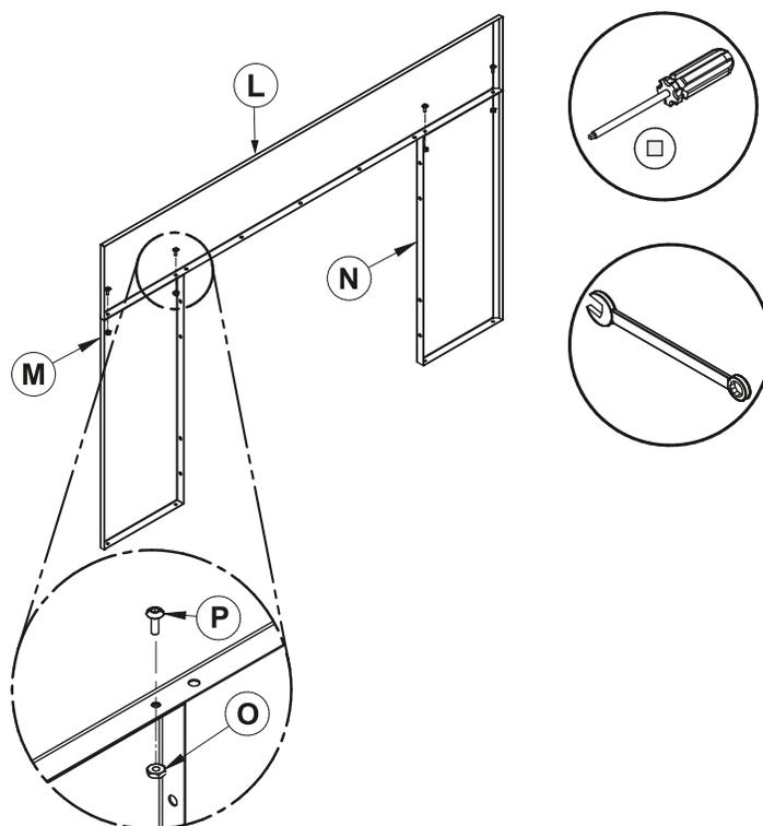
3. Ensuite, alignez les trous dans l'extension de la façade (**K**) avec les trous dans chaque panneau latéral de la façade et fixez-les en utilisant les six boulons (**P**) et écrous (**O**) fournis.
