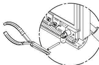
2. Tourner la poignée d'un tour dans le sens contraire des aiguilles d'une montre afin d'augmenter la pression entre le cadrage de la porte et la structure du foyer.
