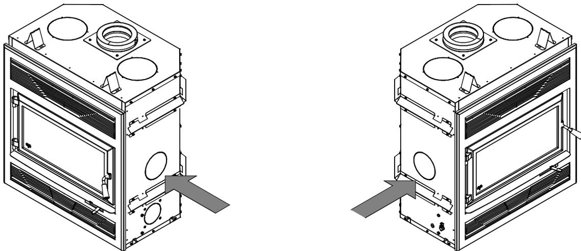
Cet ensemble permet de distribuer la chaleur vers une autre pièce jusqu'à 50' (15 m) du foyer. Le tuyau isolé flexible (non compris dans l'ensemble) doit être de type HVAC et être conforme aux normes ULC S110 et/ou UL 181, classe 0 ou classe 1 et doit résister à des températures allant jusqu'à 250 °F.
