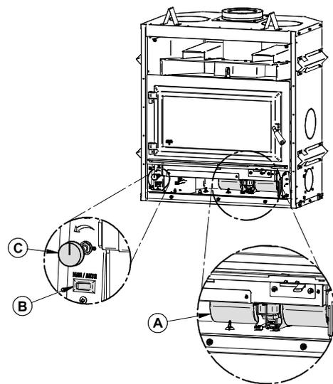
Mode automatique : Appuyer sur l'interrupteur **(B)** et choisir le mode « AUTO ». Choisir la vitesse de fonctionnement du ventilateur avec le bouton du rhéostat **(C)** au-dessus. Le ventilateur démarrera automatiquement lorsque le foyer sera chaud et s'arrêtera automatiquement lorsque le foyer sera froid.
