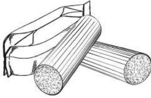
Les bûches densifiées faites à 100 % de sciure comprimée peuvent être brûlées, à condition de ne pas brûler trop de ces bûches à la fois. Ne pas brûler de bûches densifiées contenant de la sciure imprégnée de cire ou de bûches contenant des additifs chimiques. **Ne pas attiser les bûches pendant la combustion.**
