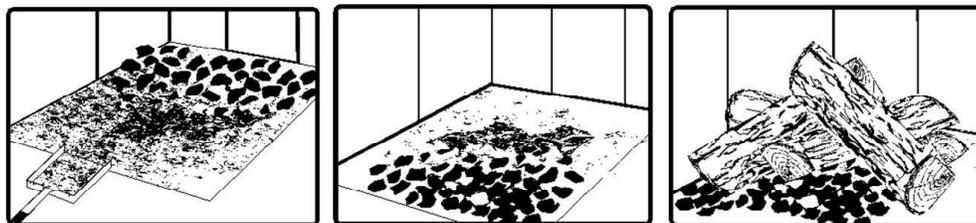
Le déplacement des braises est utile pour deux raisons. Tout d'abord, cela les rassemble près de l'endroit où la plus grande partie de l'air entre dans la chambre à combustion. Elles peuvent enflammer la nouvelle charge rapidement. Deuxièmement, les braises ne seront pas étouffées par la nouvelle charge de bois. Lorsque les braises sont simplement étalées, la nouvelle charge brûle en amortissant longtemps avant de s'enflammer.
