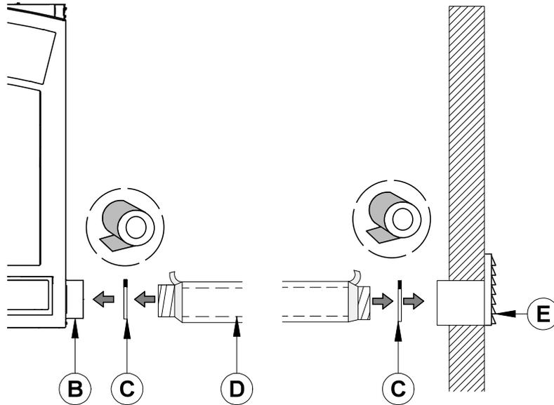
4. Pour compléter l'installation, faire un trou de 1/4" à 1/2" (6 mm à 13 mm) de plus que le diamètre du tuyau dans le mur extérieur de la maison à l'endroit choisi. De l'extérieur, placer la grille d'air extérieure dans le trou (la face ouverte vers le bas) et fixer la grille au mur.
