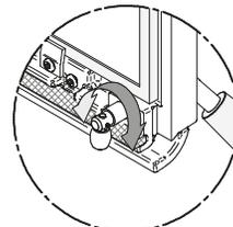
3. Réinstaller la goupille de retenue fendue en utilisant un petit marteau.
