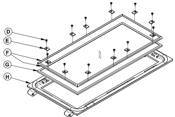
*Les deux principales causes de bris de vitre sont un placement inégal de la vitre dans la porte et un serrage excessif des vis.*
