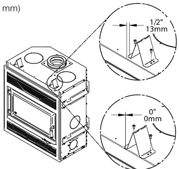
**Ne pas utiliser de matériaux combustibles pour le châssis situé directement au-dessus du foyer. Cette zone doit rester vide sur une hauteur de 80" (2,03 m) à partir de la base du foyer.**
