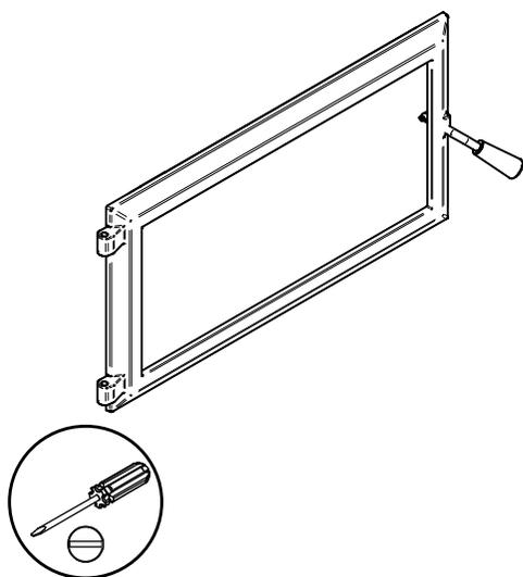
À l'aide d'un tournevis plat, tourner les tiges de pentures ajustables dans les sens indiqués pour ajuster les portes. Resserrer les vis de pression sur les gonds de porte lorsque ces dernières sont aux positions désirées.
