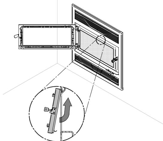
4. Soulever le pare-étincelles et pousser la partie inférieure vers le foyer puis le laisser descendre jusqu'à ce que les crochets du bas soient derrière le rebord inférieur de l'ouverture de porte.
