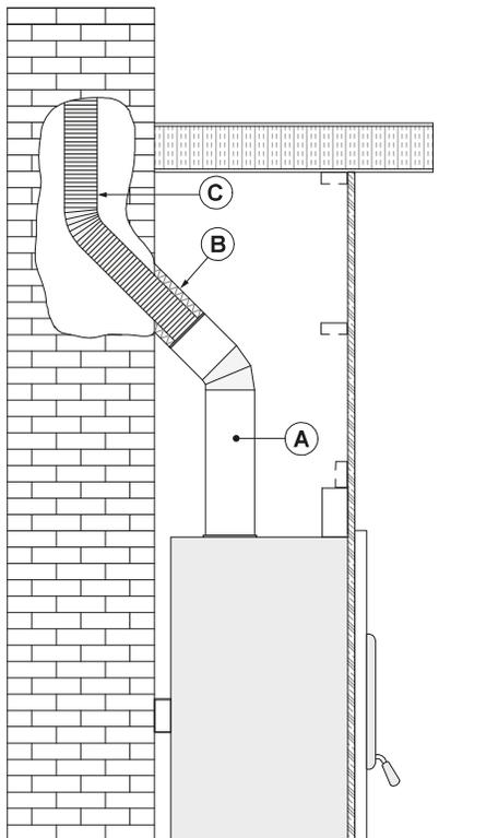
1. Placer le foyer à l'endroit désiré. Installer un coude ou une section de cheminée **(A)** temporairement sur le dessus du foyer. Marquer l'endroit où le conduit de fumée traversera dans la cheminée de maçonnerie.
