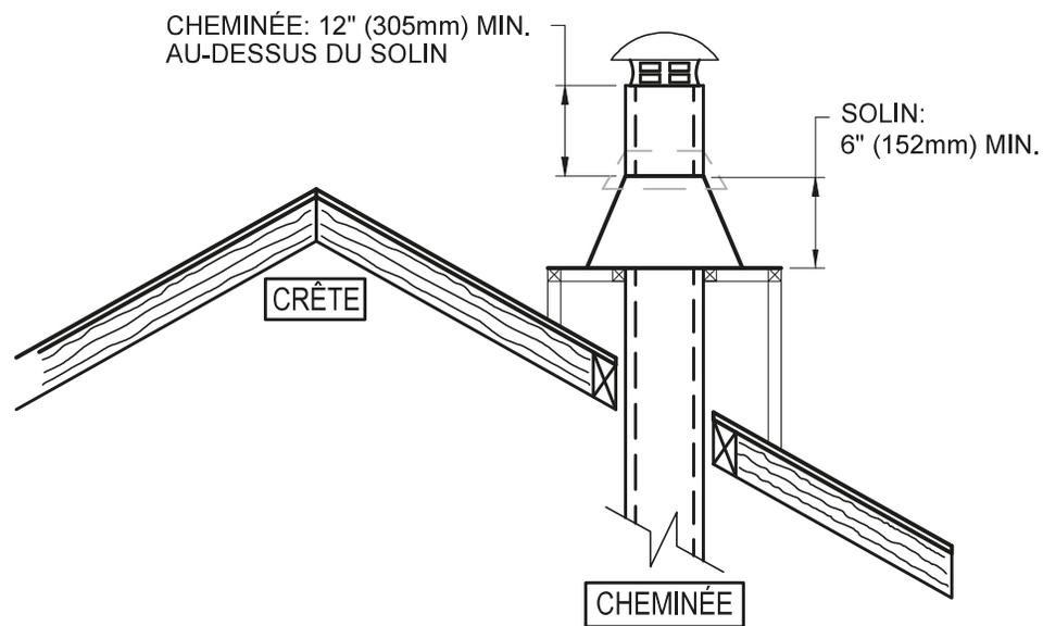
**Note : L'enceinte de la cheminée sur le toit doit être de la même dimension que la base du solin.**
